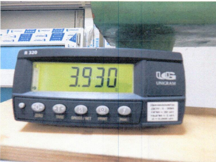
Сопротивление статической нагрузке (сила растяжения), приложенной к верхней петле устройства поворотно-откидного мод. TITAN AF .
